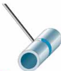
PF Rohr: fest 5Gu Achse: waagrecht Schweißung: steigend
