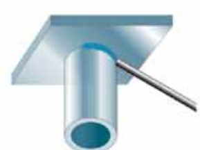
PD Rohr: fest 4F Achse: senkrecht Schweißung: horizontal-überkopf
