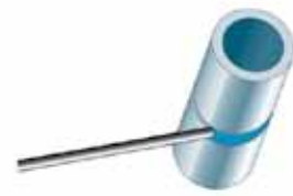
H-LO45 Rohr: fest 6G Achse: geneigt Schweißung: steigend
