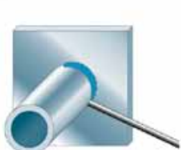
PG Rohr: fest 5Fd Achse: waagrecht Schweißung: fallend
