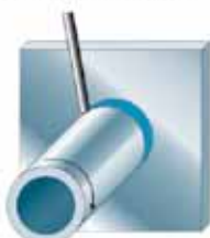
PB Rohr: rotierend 2F Achse: waagrecht Schweißung: horizontal-vertikal
