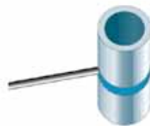
PC Rohr: fest 2G Achse: senkrecht Schweißung: quer
