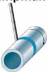
PA Rohr: rotierend 1G Achse: waagrecht Schweißung: Wanne
