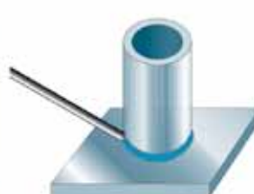
PB Rohr: fest 2F Achse: senkrecht Schweißung: horizontal-vertikal
