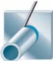
PF Rohr: fest 5Fu Achse: waagrecht Schweißung: steigend
