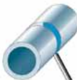
PG Rohr: fest 5Gd Achse: waagrecht Schweißung: fallend
