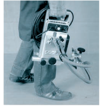
ProFIT ist aufgrund eines Leichtmetallgehäuses bequem tragbar
