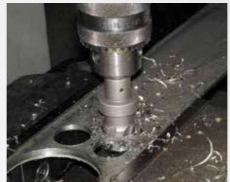
Bohren in Flachstahl
