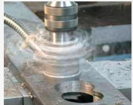
Bohren in Flachstahl
