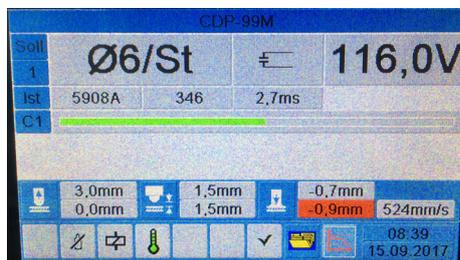
**Bild 1 oben: Wegemessung ohne Prozessüberwach (ohne Aufzeichnung)**
