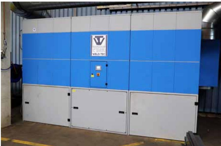
**links** Die kompakte Absauganlage ist leistungsstark, leise und W3-zertifiziert.
