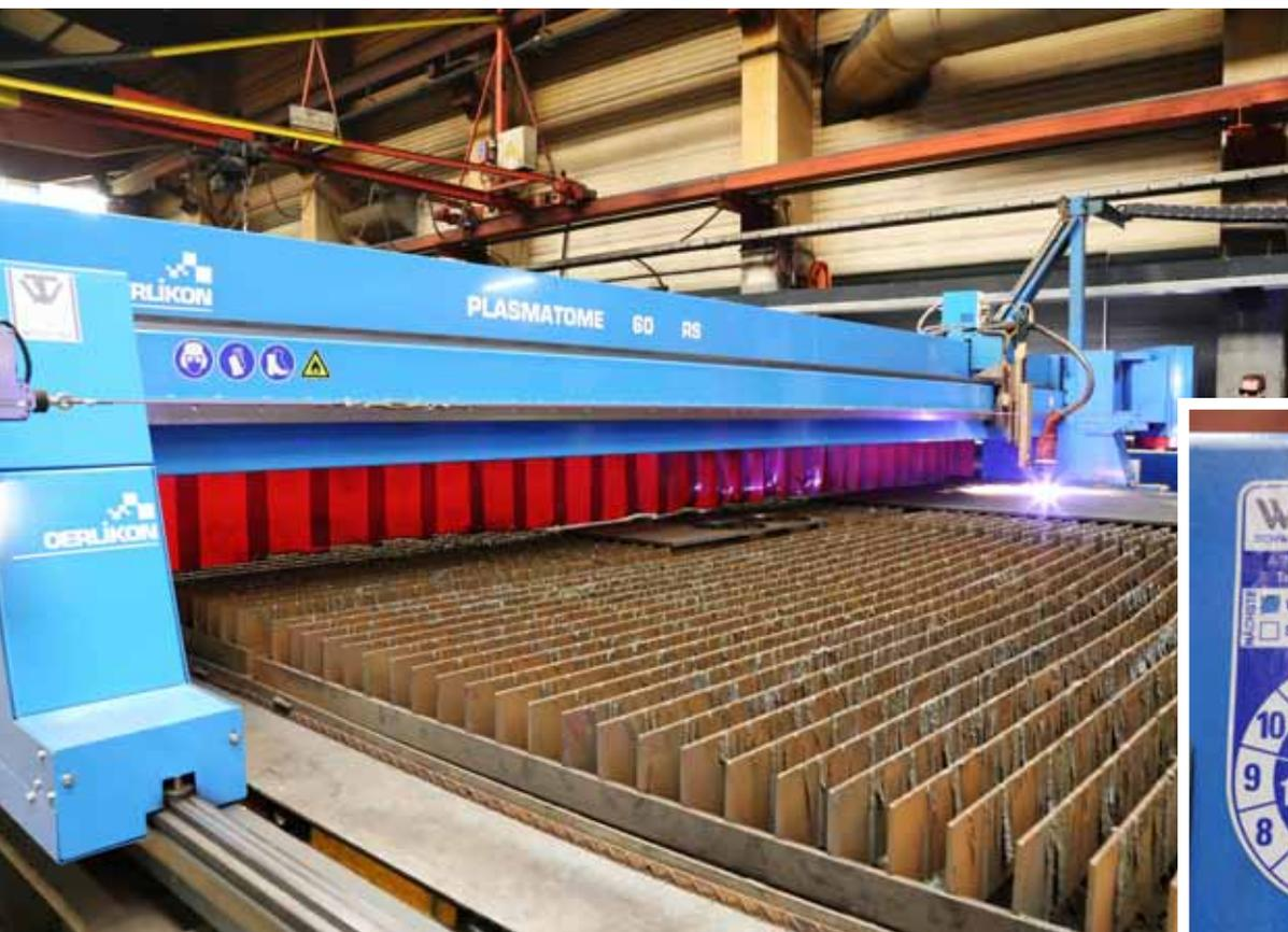
**links** Mit der neuen Plasmaschneidanlage, die Materialstärken bis zu 50 mm schneidet, konnte die Produktvielfalt bei Wagner wesentlich erweitert werden.
