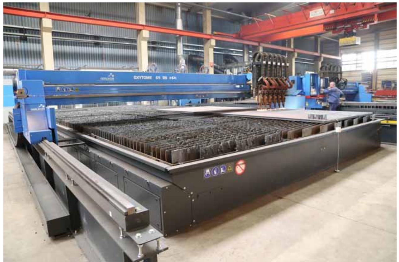
**oben** Der Brennschneidisch lässt bis zu 100 Tonnen Materialauflage zu.
