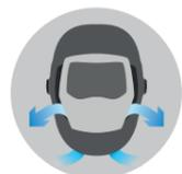
1 Flügelventile – ausgeatmete Luft wird über die Flügelventile abgeleitet.
