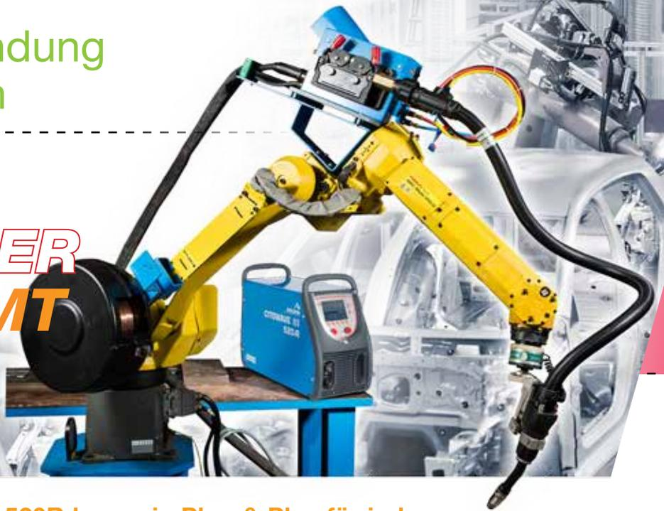
Der Roboter *CITOWAVE III 520R* kann via Plug & Play für jede Roboteranwendung schnell und einfach eingesetzt werden.
