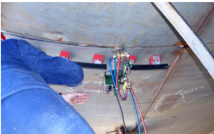
Über Kopfschneiden möglich durch starke Dauermagneten
