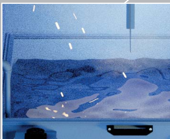
Die Funken fallen ins Wasserbad und erlöschen
