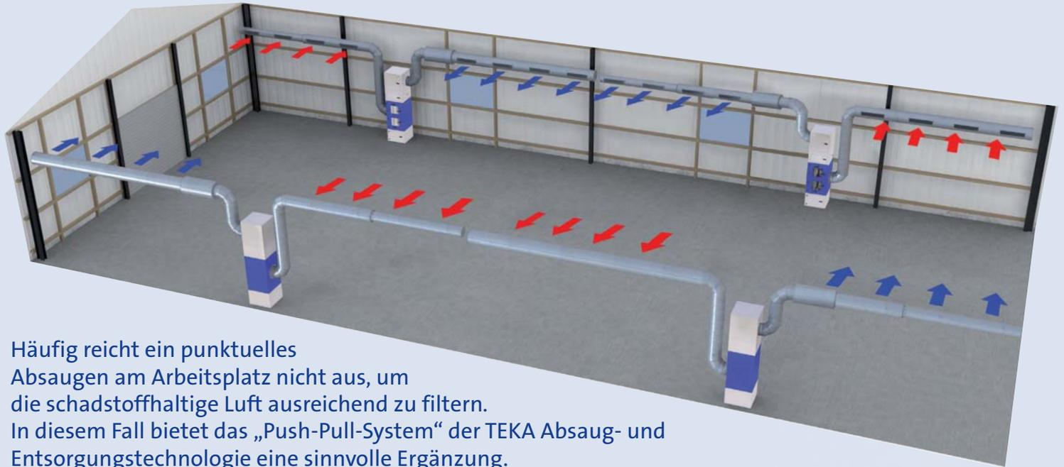
Häufig reicht ein punktuelles Absaugen am Arbeitsplatz nicht aus, um die schadstoffhaltige Luft ausreichend zu filtern. In diesem Fall bietet das „Push-Pull-System“ der TEKA Absaug- und Entsorgungstechnologie eine sinnvolle Ergänzung.
