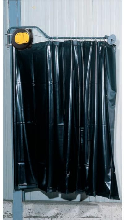
Zunächst wird der Vorhang auf den festen Teil des Halters geschoben. Dann löst man die Spannvorrichtung für das Seil und nimmt den Handgriff aus der Spannvorrichtung. Das Stahlseil läuft jetzt automatisch in den Aufroller zurück. Es empfiehlt sich das Seil bis zum Vorhanghalter zu führen. Der Vorhanghalter kann jetzt um 180° geschwenkt werden und damit ist der Weg in nur wenigen Minuten frei.
