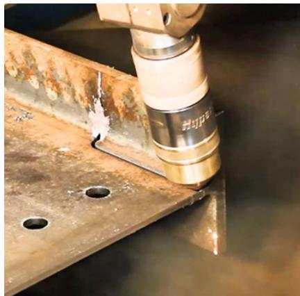
Abbildung 7. Gesteuerter Zuschnitt einer Trägerausklinkung
