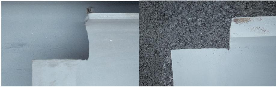
Abbildung 6. Schlechte Praktiken beim Schneiden von Trägerausklinkungen
