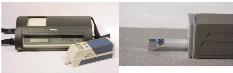
Abbildung 26. Kontakt-Oberflächenrauheitsmessinstrument
