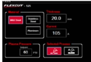
**Prozessverwaltung:** Alle Parameter werden von der Schnittstelle aus gesteuert, abhängig von der einfachen Materialwahl und Materialdicke, und vereinfacht den Plasmaschneidprozess. Mehrere Funktionen erhöhen die Produktivität wiederkehrender Abläufe und kompensieren automatisch den Verschleiß von Verbrauchsmaterialien.
