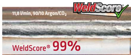
Akzeptables Ergebnis - Korrekter Gasfluss und Gasabdeckung sorgen für eine gute Schweißnaht ohne Poren.
