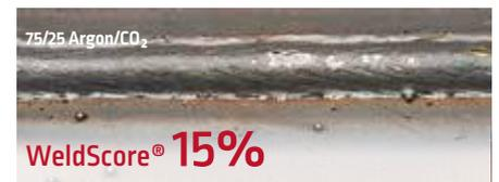
Inakzeptable Schweißnaht - Falsche Gasmischung führt zu mehr Spritzern.
