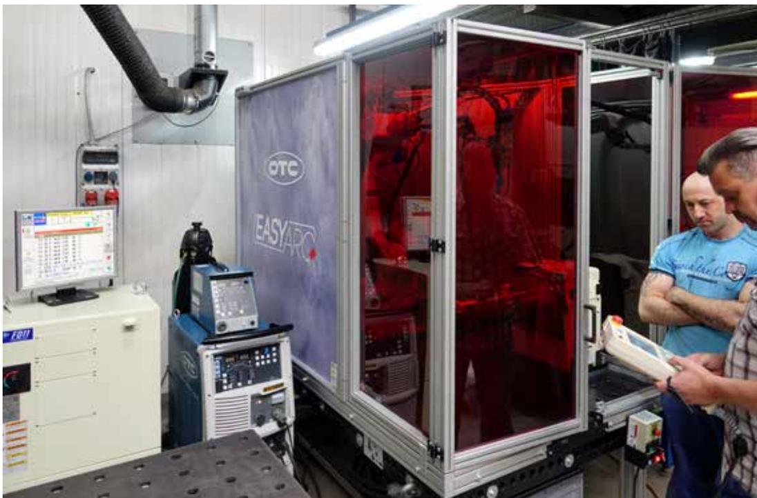
**links** Der OTC-Controller FD-11 (links) sowie die wassergekühlte OTC Stromquelle Welbee A350P (Mitte) sind **Bestandteil des Gesamtpaketes.**
