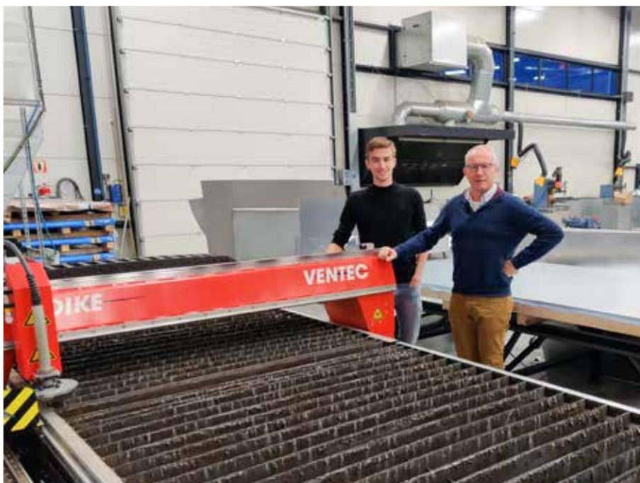
Die Koike Ventec hat die Erwartungen von **GMM-Inhaber Dick Visch** (rechts) mehr als übertroffen: Sie ist schneller, bietet eine bessere Schnittqualität sowie Schnittgenauigkeit und benötigt zudem praktisch keine Wartung.
